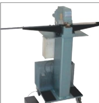
**56-0-H** Hydraulische Schere für gerade Schnitte, Schneiden von Nasen und Doppelnasen. 700 mm Schiebelehre. Maximale Schneidekapazität: 6 Punkt, 100,00 mm. Auch verfügbar: **56-0** (die Handversion ist ausschließlich für gerades Schneiden).
