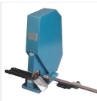
**47-0-P** Pneumatische Schere für gerades Schneiden, zum Schneiden von Nasen und Doppelnasen. Nur für Facetten-Schneidlinien. 400 mm Schiebelehre. Maximale Schneidekapazität: 4 Punkt, 32,00 mm. Bitte beachten: Diese Maschine ist voreingestellt für 2, 3 oder 4-Punkt-Schneidlinien. Auch verfügbar: **47-0** (Handversion).
