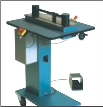
**49-0** Elektrische Kreisbiegemaschine. Zur Herstellung von Kreisen und Kurven. Mindestdurchmesser: 12,00 mm (2 Punkt). Maximale Kapazität: 4 Punkt, 50,00 mm.
