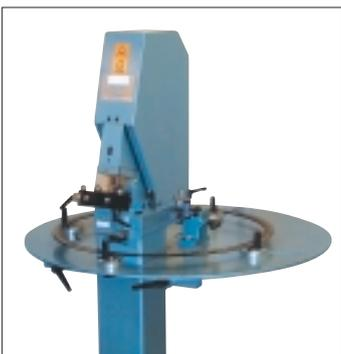
**53-0-R** Pneumatische Schere für Rotationsschneidlinien, gerade oder kurvig. Gerades Schneiden, Schneiden von Nasen und Doppelnasen sowie Ausklinkungen. Maximale Schneidekapazität: 4 Punkt, 32,00 mm. Auch verfügbar: **54-0-R** (Pneumatischer Hochleistungsaußlinker).
