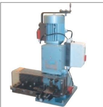
**55-0** Elektrisches Gerät für die Herstellung von Perforierlinien und Schneid-Rill-Linien. Justierbar. Maximale Schneidekapazität: 4 Punkt, 30,00 mm.
