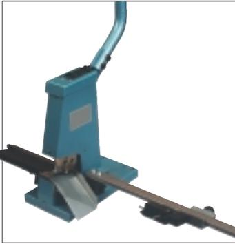
**42-0** Handschere für gerade Schnitte, das Schneiden von Nasen und Doppelnasen. 400 mm Schiebelehre. Maximale Schneidekapazität: 4 Punkt, 32,00 mm. Auch verfügbar: **42-0-P** (pneumatische Ausführung).
