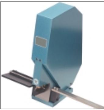
**48-0-P** Pneumatische Schere für gerades Schneiden. Für hohe Schneidlinien und Ausbrechlinien. Sowohl für gebogene als auch für gerade Schneidlinien. 400 mm Schiebelehre. Maximale Schneidkapazität: 4 Punkt, 50,00 mm. Auch verfügbar: **48-0** (Handversion).
