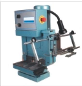
**32-0** Elektrische Kombinationschere für gerade Schnitte, das Schneiden von Nasen und Doppelnasen. Für sowohl gebogene als auch gerade Schneidlinien. 400 mm Schiebelehre. Maximale Schneidekapazität: 4 Punkt, 60,00 mm.
